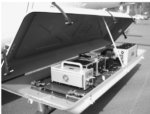
Abb. 4: Eurocopter AS 350, Laserscannsystemen sowie RGB-Digital-Framekamera & INS.
