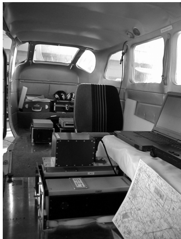
Abb. 2: (Innenraum Cessna 207 B, zwei Laserscannern sowie INS).
