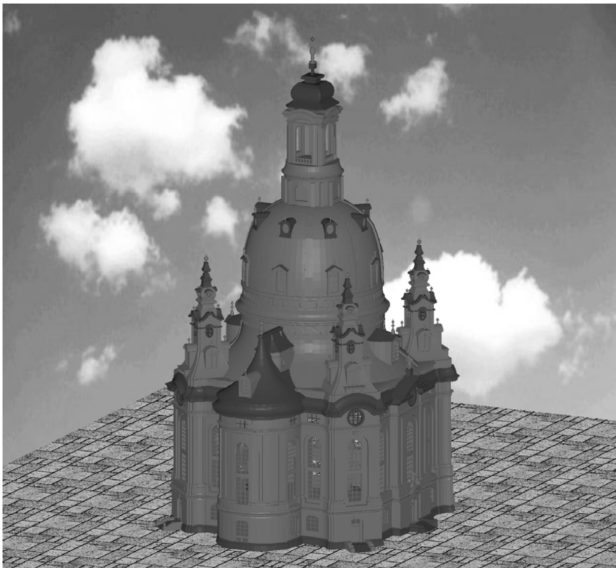
Abb. 16: 3D CAD Komplexmodell mittels ALS & TLS Daten.
